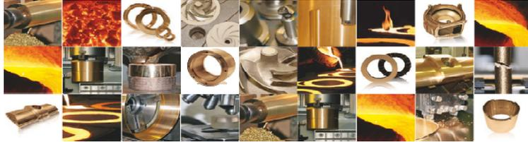
Schleuderguss wird fast ausnahmslos mit geringsten Bearbeitungszugaben vorgedreht, während Strangguss auch in Vordrehqualität roh geliefert wird.
